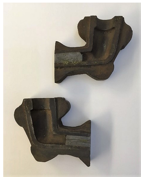
Afb. 7. Mal van Scouflaire voor een pijp met losse steel. Collectie Musée de Nimy.
