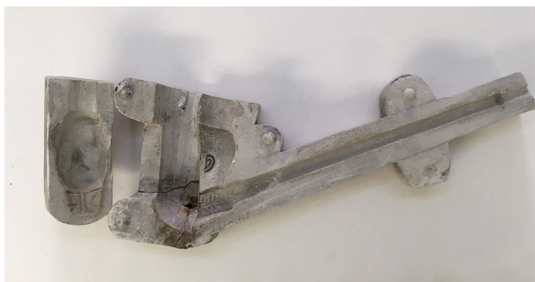
Afb. 55. Een mal van een Koning Albert I pijp. Afgeleid van een pijp die oorspronkelijke in Andenne gemaakt is. Collectie Musée de Nimy.
